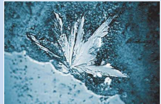
Durch Magnetismus deutlich feinere Kalkstruktur. (Probe Aquavital, 400-fach vergrößert)
